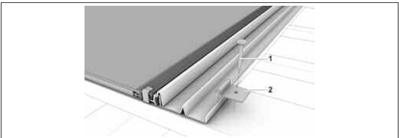
Bild 4-17: Anschlussblech mit Blechhaften befestigen
