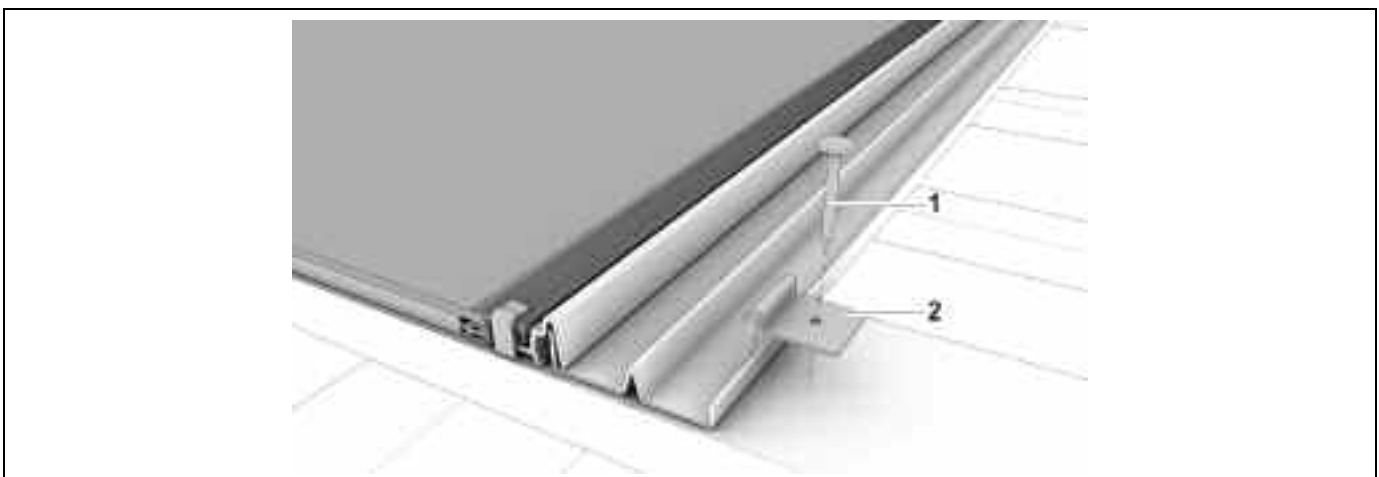
Bild 4-17: Anschlussblech mit Blechhaften befestigen
