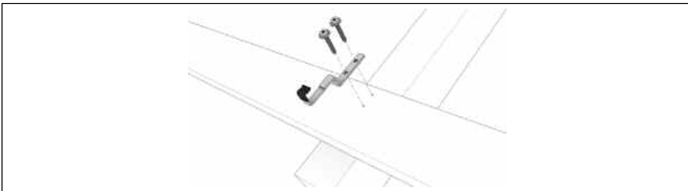
Figure 3-4: Etrier de montage « verre »
