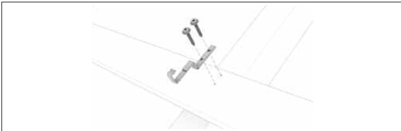
Figure 4-5: Fixer les étriers de montage „Profil“
