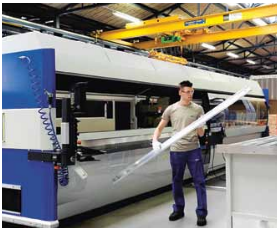
Atelier de Hedingen: nouveau centre d’usinage pour Solrif™ et capteurs solaires
