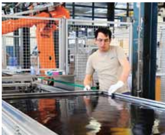
Atelier de Hedingen: nouvelle ligne de production pour le capteur pour toit plat FK 2
