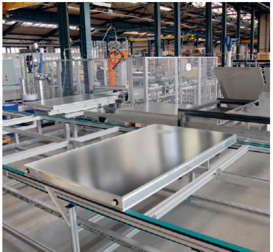
Erweiterte Produktion, mehr Kapazität – die zweite Produktionsstrasse für den neuen Kollektor FK 2.
